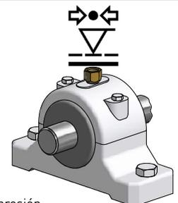
Prueba de presión: Punto de lubricación / todas las conexiones (ver otras indicaciones en el manual de instalación de perma FUTURA)
