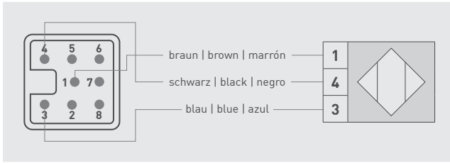
Figura 10-5 Diagrama de conexiones para la conexión del perma ECOSY Sensor de control
