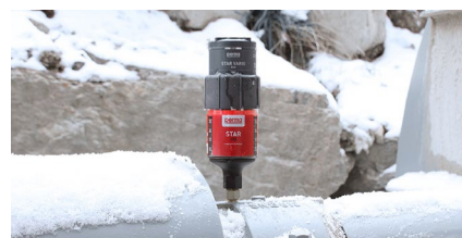
Lubricación del soporte de una báscula de cinta transportadora
