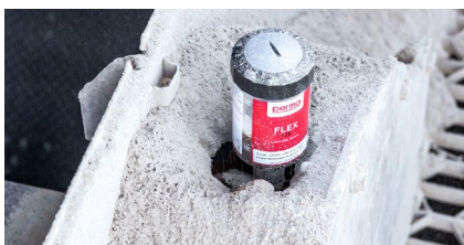
Lubricación del soporte de un rodillo de cola
